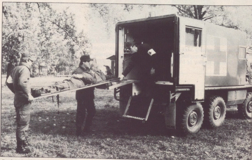
Sanitätskraftwagen (Pinzgauer) — Neben dem Kommandanten, dem Kraftfahrer und einem Sanitäter können vier liegende oder acht sitzende Kranke bzw. Verwundete, sowohl auf Straßen als auch im Gelände transportiert werden.
